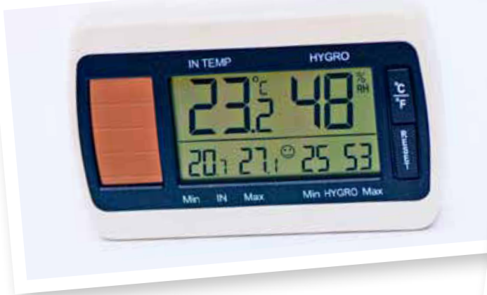
Oben: Ein Thermo-Hygrometer ermittelt Raumtemperatur und Luftfeuchtigkeit. Rechts: Thermostatventile haben Fühler und brauchen nicht voll aufgedreht zu werden.
